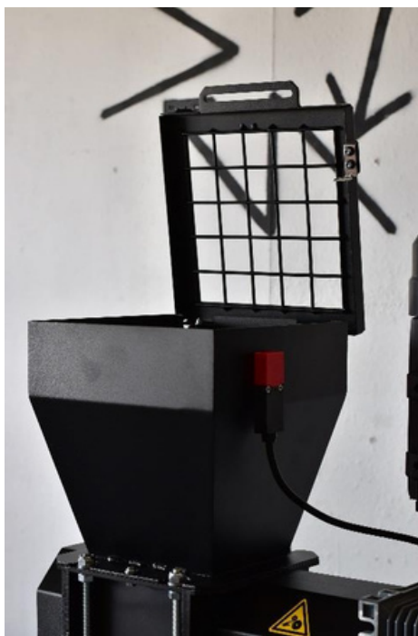
Figure 4 : Entonnoir avec sécurité électrique
